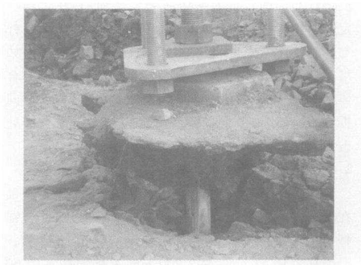
图2 5号试验点单锚基础破坏形态
