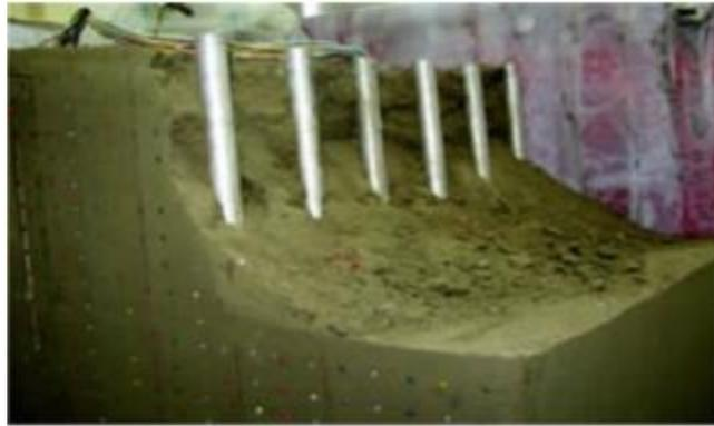
图 3 离心机模型试验后基坑形态
