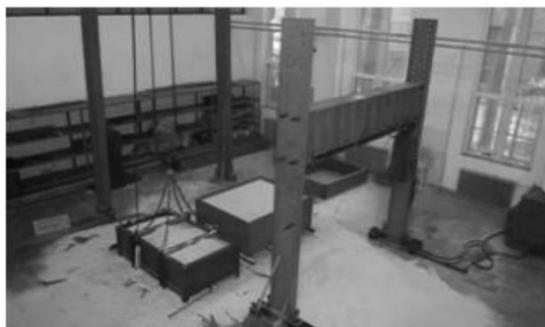
图3 砂雨法试验装置
