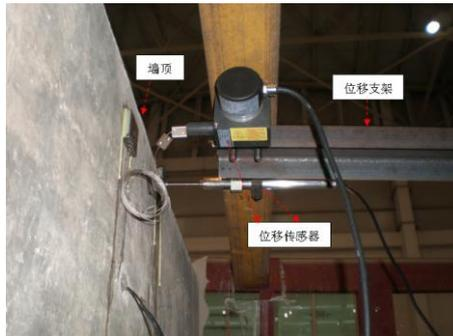
图3 重力式挡土墙位移传感器安装图
