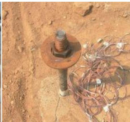
图7 单锚锚筋拔断
