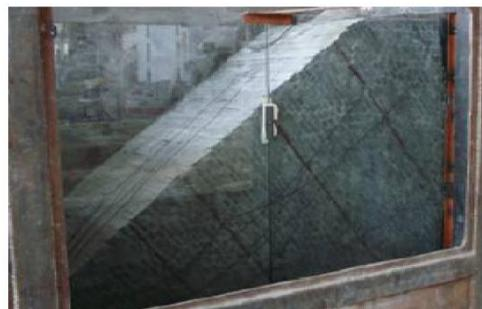
图2 砌筑完毕的边坡模型
