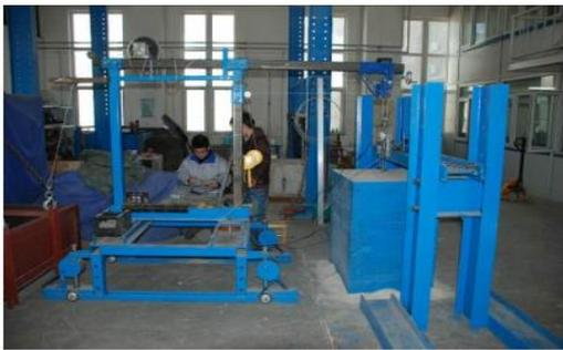
图5 扩体锚杆模型试验照片
