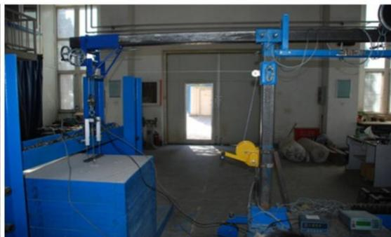
图 4 扩体锚杆模型试验系统
