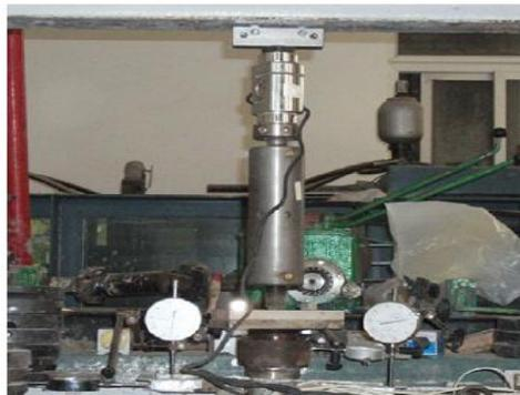
图2 竖向荷载加载装置
