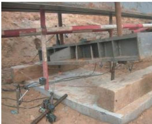
图6 群锚单根锚筋拔断
