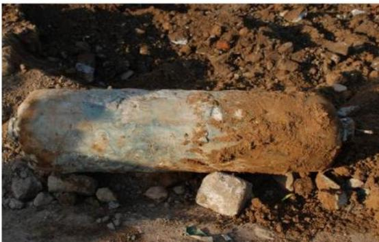
图1 多重防腐囊式扩体锚杆(CJY-KT锚杆)
