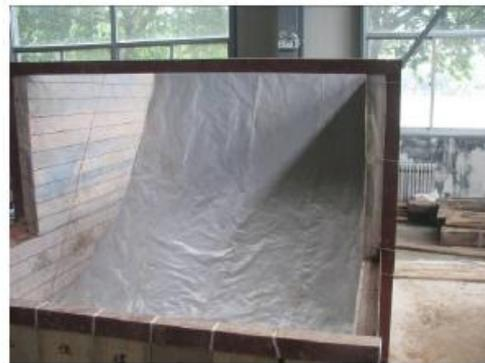
图4 滑面双层塑料薄膜
